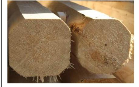
La squadratura intacca solo superficialmente le fibre, determinando una più elevata resistenza meccanica.
