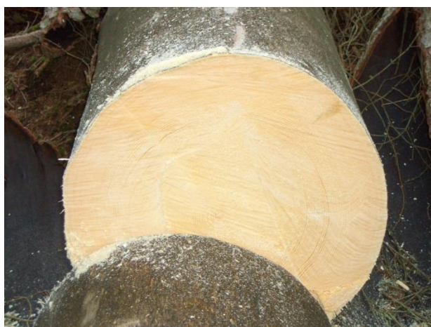
Foto 5: tondame privo di difetti (taglio 21 giugno, tronco con cimale; foto scattata al momento della depezzatura)
